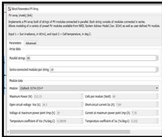
Fig-8 Solar Panel Parameters
