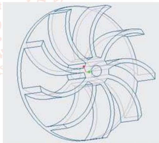
Fig. 2 Impeller
