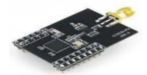
Fig.2. XCore2530 ZigBee module
