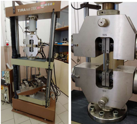
Fig. 2 The tensile test machine TIRAtest 2300
